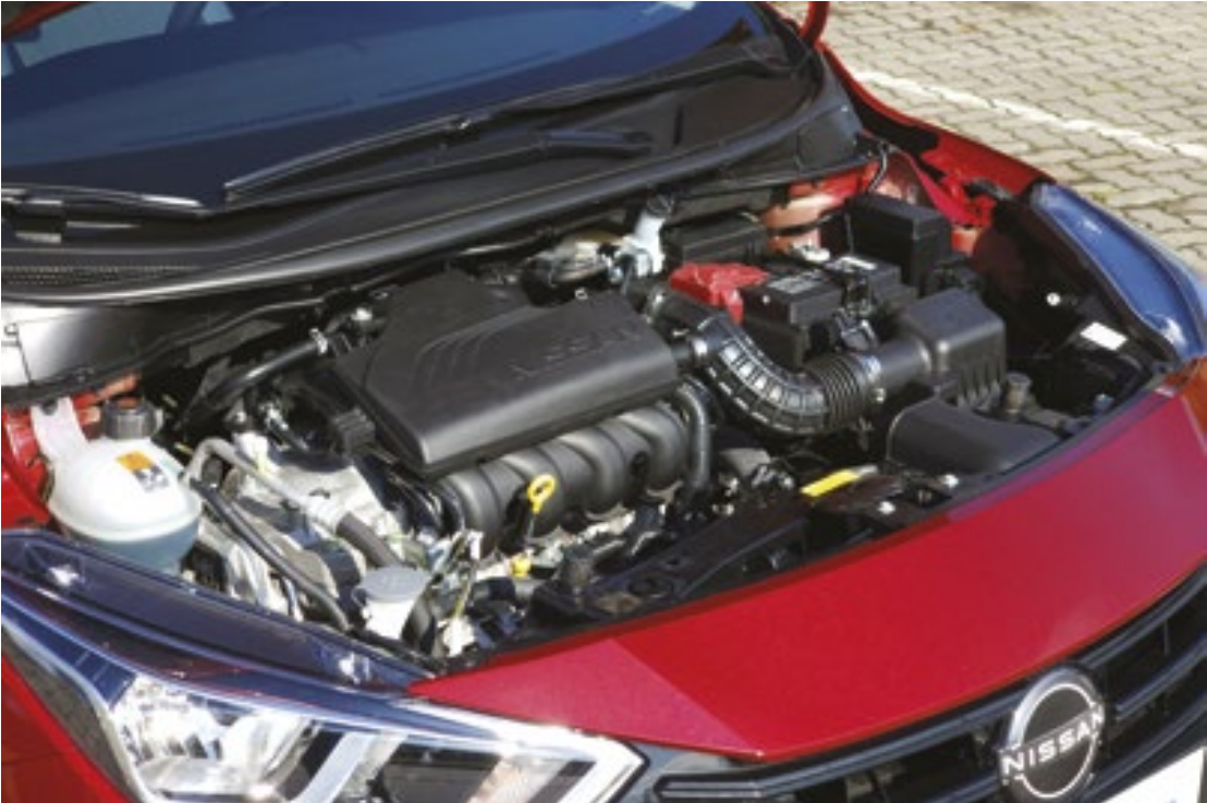
O conjunto formado pelo motor 1.6 16V Flex e pela transmissão Xtronic CVT com 5 marchas simuladas entrega 113 cavalos de potência e torque de 15,3 kgfm quando abastecido com etanol
